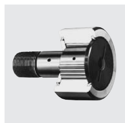
Kurvenrolle KRV..PP Axialführung über Anlaufbund und -scheibe, vollnadelig, abgedichtet
