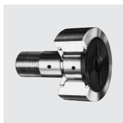
Kurvenrolle KR..PP Axialführung über Anlaufbund und -scheibe, abgedichtet
