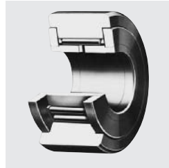
Stützrolle NATR Axialführung über Anlaufscheiben
