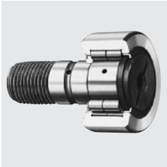
Kurvenrolle NUKR Axialführung über Wälzkörper, vollrollig
